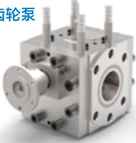
EXTRU增压/挤塑齿轮泵主要用于挤塑机或中高粘度聚合物的增压和稳定流量输送。有液相/电加热两种加热方式。由于聚合物通过管路以及过滤器的压力损失，在这些工艺中需要对聚合物增压。
