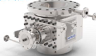
POLY齿轮泵用于输送真空反应器中的中高粘度介质。超大的吸入口, 在真空或较低的NPSH的条件下, 使高粘介质能够很好的吸入齿轮泵。
